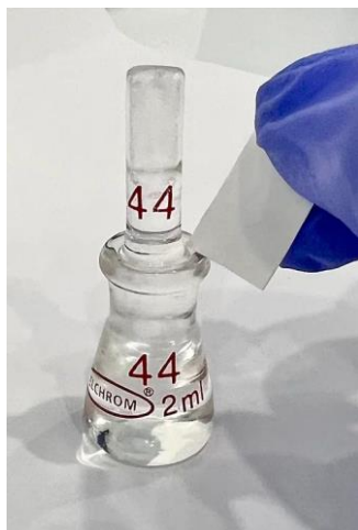
Рис. П3 – Удаление воды с поверхности пикнометра
