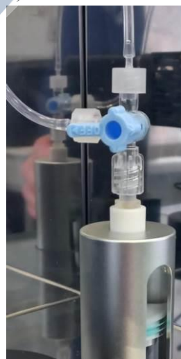
Рис. 5. Заполнение резервуара дозатора водой
