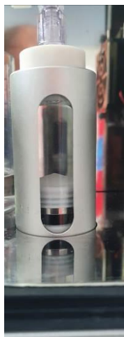
Рис. 5 (продолжение). Заполнение резервуара дозатора водой
