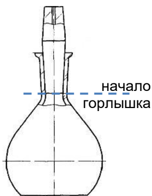
Рисунок 2. Заполнение пикнометра водой
