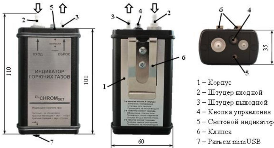
Рисунок 1. Общий вид и габаритные размеры прибора «ELCHROMDET»
